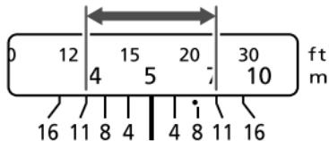
Глубина резкости – это диапазон пространства (расстояния) спереди и сзади плоскости фокуса на объекте, которое изображается резким.
