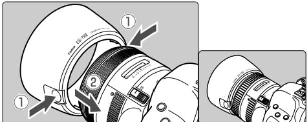
Бленда ES-79 II не допускает нежелательные блики и свет на линзы объектива, а также защищает объектив от попадания на поверхность линзы дождя, снега и пыли. Надевайте бленду на объектив, следуя нижеприведенной процедуре.
