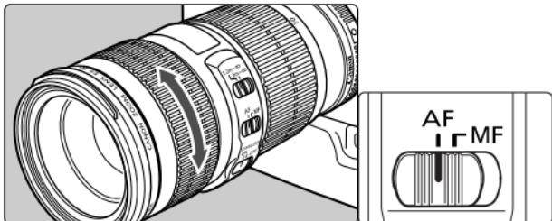
Для съемки в режиме автоматической фокусировки (AF) установите переключатель режимов фокусировки в положение AF. Чтобы использовать ручную фокусировку (MF), установите переключатель режимов фокусировки в положение MF и настройте фокусировку, поворачивая фокусировочное кольцо. Фокусировочное кольцо функционирует всегда, независимо от установленного режима фокусировки.
