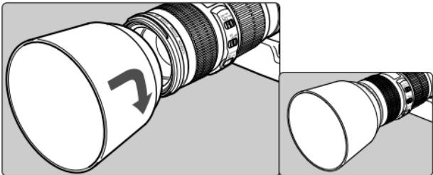
Бленда ET-74 не допускает нежелательные блики и свет на линзы объектива, а также защищает объектив от попадания на поверхность линзы дождя, снега и пыли.
