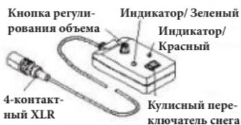
4. Нажмите кнопку ON/OFF, индикатор IN USE загорится зеленым, генератор готов к работе (во время выполнения этих операций начинают свою работу вентиляторы и мотор генератора).
