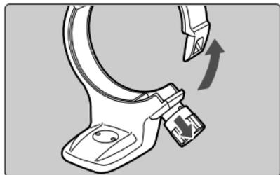
**1** Поверните винт замка против часовой стрелки, чтобы его ослабить (около 3 поворотов), затем потяните винт в направлении, указанном стрелкой, чтобы расцепить воротник штативной пятки.
