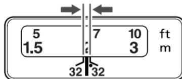
Глубина резкости – это диапазон пространства (расстояния) спереди и сзади плоскости фокуса на объекте, которое изображается резким. Глубина резкости обозначается зоной между линиями на шкале глубины резкости под шкалой расстояний.
