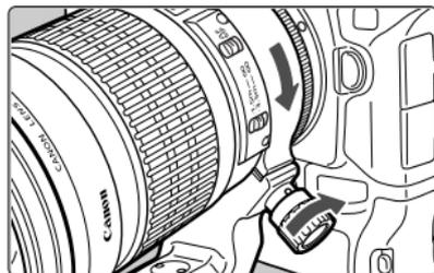
**3** Чтобы смонтировать штативную пятку на объективе, оттягивая наружу винт замка, верните воротник в изначальное положение и надежно затяните винт замка.
