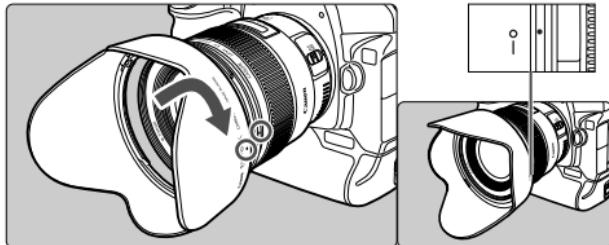
Бленда EW-83K не допускает нежелательные блики и свет на линзы объектива, а также защищает объектив от попадания на поверхность линзы дождя, снега и пыли.
