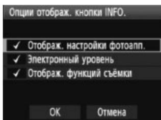
При нажатии кнопки <INFO.> когда камера готова к съемке, можно отобразить параметры [Отображ. настройки фотоапп.], [Отображ. функций съёмки] (стр. 225), и [Электронный уровень] (стр. 48). На вкладке [☺:] параметр [Опции отображ. кнопки INFO.] позволяет выбрать параметр, который должен отображаться при нажатии кнопки <INFO.>.
