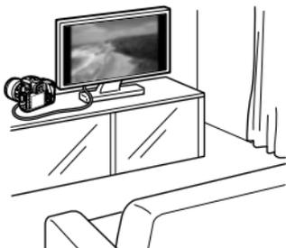
Для подсоединения камеры к телевизору пользуйтесь аудио/видеокабелем, входящим в комплект камеры, или кабелем HDMI HTC-100 (продается отдельно). После этого можно просматривать сделанные видеозаписи и фотографии на экране телевизора. При наличии телевизора высокой четкости (High-Definition TV), появляется возможность просмотра видеозаписей с повышенным качеством изображения по стандартам Full HD (Full High-Definition 1920x1080) и HD (High-Definition 1280x720).
