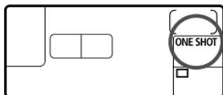
**Подходит для неподвижных объектов. При нажатии кнопки спуска затвора наполовину камера фокусируется только один раз.**
