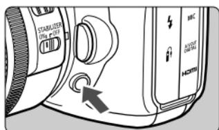
Нажав кнопку предварительного просмотра глубины резкости, можно привести диафрагму объектива в соответствие с текущей установкой. В видоискателе можно проверить глубину резкости (диапазон приемлемой фокусировки).
