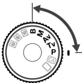
В режимах съемки **P/Tv/Av/M/B** можно выбирать выдержку, диафрагму и другие установки камеры, чтобы изменять экспозицию и добиваться требуемого результата.
