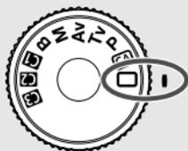
**Поверните диск установки режима в положение <□> (Полностью автоматический режим).** (стр. 50).
