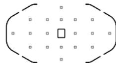
В режиме AI Servo AF (следающая автофокусировка) выбранная вручную (р. 88) точка автофокусировки <□> используется для наводки на резкость в первую очередь. Эту настройку невозможно задать в полностью автоматических режимах (□/CA).
