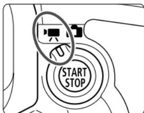
Видеосъемка включается при установке переключателя съемки с использованием ЖКД-видеоискателя/ видеосъемки в положение
