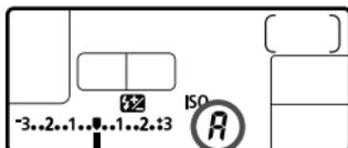
Если для чувствительности ISO задано значение «А», фактически устанавливаемое значение чувствительности ISO отображается при нажатии кнопки спуска затвора наполовину. Как указано ниже, чувствительность ISO автоматически устанавливается в соответствии с режимом съемки.
