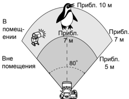
Здесь приведены инструкции по полностью автоматической съемке с внешней вспышкой Speedlite и встроенной вспышкой с беспроводным управлением. Можно изменить соотношение мощностей внешней вспышки Speedlite и встроенной вспышки для желаемой подсветки теней.
