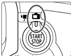
Можно производить съемку, просматривая изображение на ЖК-дисплее камеры. Это называется «Съемка с использованием ЖКД-видоискателя». Съемка с использованием ЖКД-видоискателя включается
