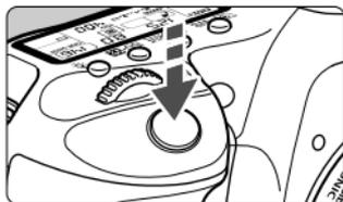
В любой момент можно производить фотосъемку, полностью нажав кнопку спуска затвора, даже во время съемки видео.
