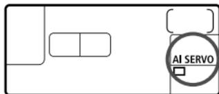
Этот режим автофокусировки предназначен для съемки движущихся объектов, когда расстояние фокусировки постоянно изменяется. Пока кнопка спуска затвора удерживается наполовину нажатой, производится непрерывная фокусировка на объект.
