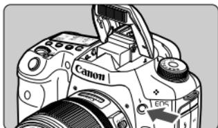
В режимах съемки **P/Tv/Av/M/B** при необходимости съемки со вспышкой достаточно нажать кнопку **<⚡>**, чтобы поднять встроенную вспышку. Если поднялась встроенная вспышка, ее можно опустить рукой. В режиме **<□>** (Полностью автоматический) встроенная вспышка срабатывает автоматически (стр. 50). В режиме **<CA>** можно выбрать автоматическое срабатывание вспышки или ручное управление (стр. 53).
