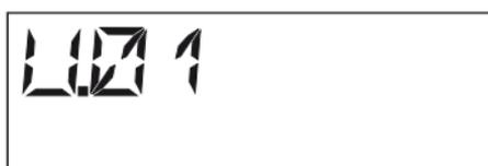
Используйте кнопки ▲/▼ для выбора нужной частоты приема или передачи. Они настраиваются шагом по 25 кГц внутри переключаемой полосы 36 МГц. Для определения свободных от интерференции частот сверьтесь с прилагаемой таблицей.
