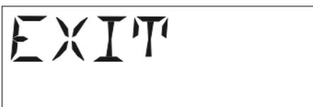
В любом рабочем меню кнопка **ON/OFF** служит как клавиша выхода ESC, т. е краткое нажатие на **ON/OFF** отменит ввод значения и обеспечит возврат к стартовому меню.
