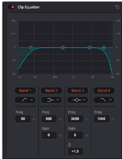
Der 4-Band-Equalizer kann auf jeden Clip in der Timeline angewandt werden
