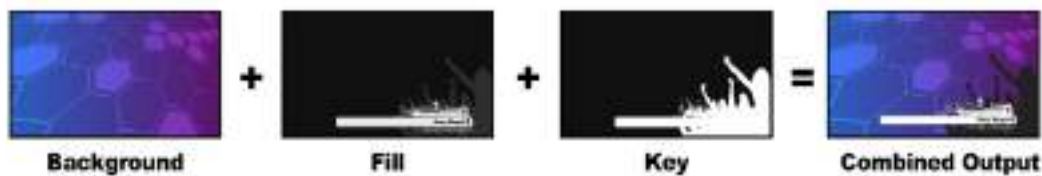
Kombination eines Hintergrunds mit Füll- und Stanzsignal in Form eines Linear-Keys
