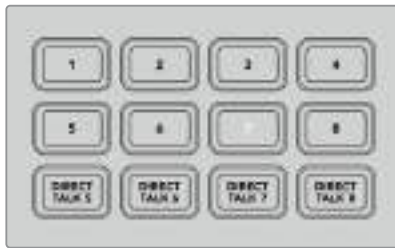
Die Ziffern- und DIRECT-TALK-Tasten ermöglichen die Kommunikation mit Kameraoperatoren
