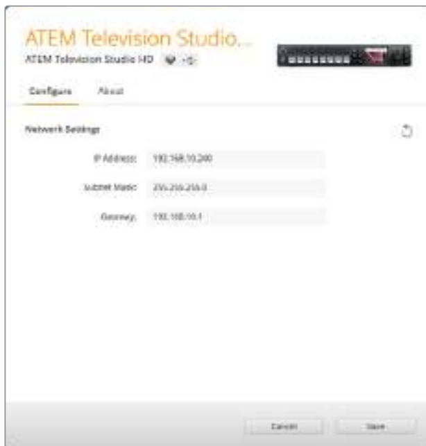
Ändern der Netzwerkeinstellungen über den „Configure“-Tab in Blackmagic ATEM Setup
