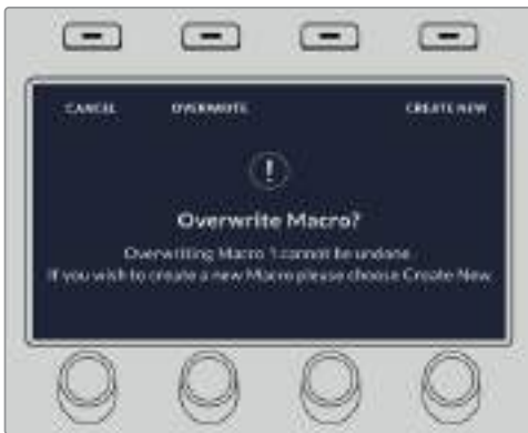
Si desea sustituir una macro existente o grabar una nueva para corregir errores, presione el botón junto al símbolo de grabación nuevamente y confirme que desea reemplazarla.
