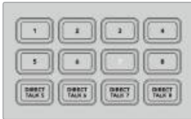
数字ボタンと「DIRECT TALK」ボタン を使用すればカメラマンと通信可能。
