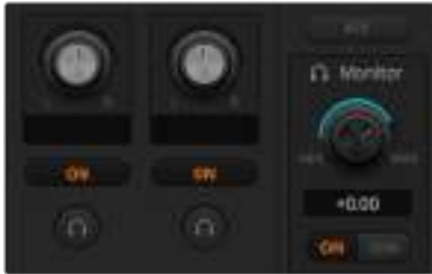
监听音量旋钮和滑块可监听节目音频及对讲和侧音设定独立的音频电平, 还可以设置混音的整体音量电平。
