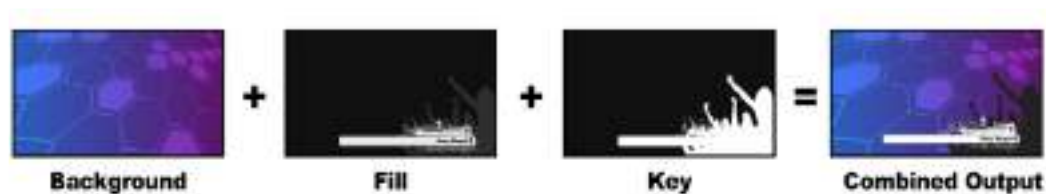
Sfondo e segnale di riempimento e chiave in una chiave lineare
