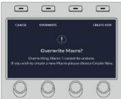
Caso queira substituir um macro existente ou gravar um novo para corrigir erros, pressione o botão de gravação e confirme que deseja substituir o macro.
