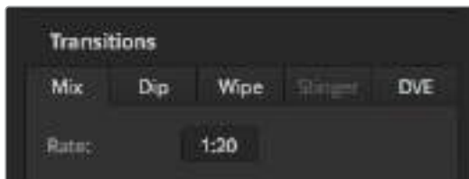
ミックス・トランジションレートは<秒：フレーム>で表示
