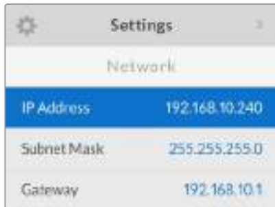
LCDメニューでネットワーク設定を変更する
