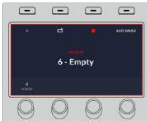
Durante la registrazione appare un bordo rosso intorno al display LCD
