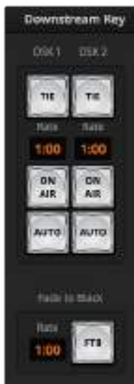
Incrustation en aval et fondu au noir
