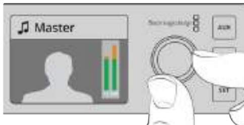
Mit dem Drehregler vorgenommene Justierungen am Masteraudiopegel können Sie auf dem LCD verfolgen
