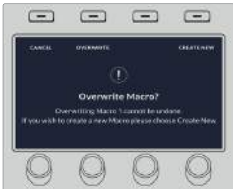
Если нужно перезаписать уже существующую макрокоманду или исправить допущенную в ней неточность, нажмите кнопку записи, а затем внесение изменений.
