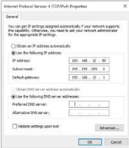
Windows bilgisayarınız için IP adresinin manuel olarak ayarlanması.
