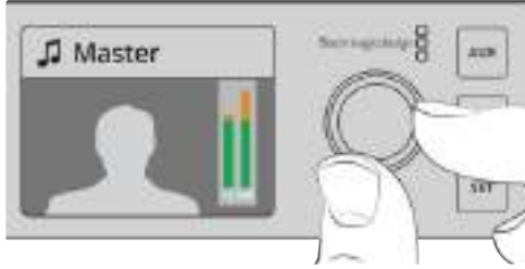
Ana ses seviyesini ayarlamak için düğmeyi kullanın ve LCD'de ana ses göstergelerinde etkisini görebilirsiniz.
