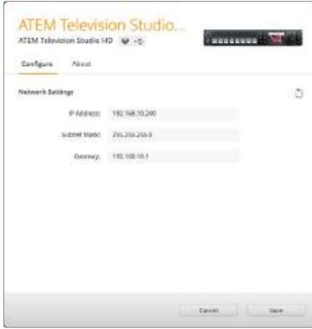
Blackmagic ATEM Setup'daki 'configure' (yapılandırma) sekmesini kullanarak ağ ayarlarını değiştirin.
