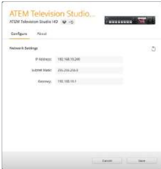
通过Blackmagic ATEM Setup软件的“配置”选项卡更改网络设置。
