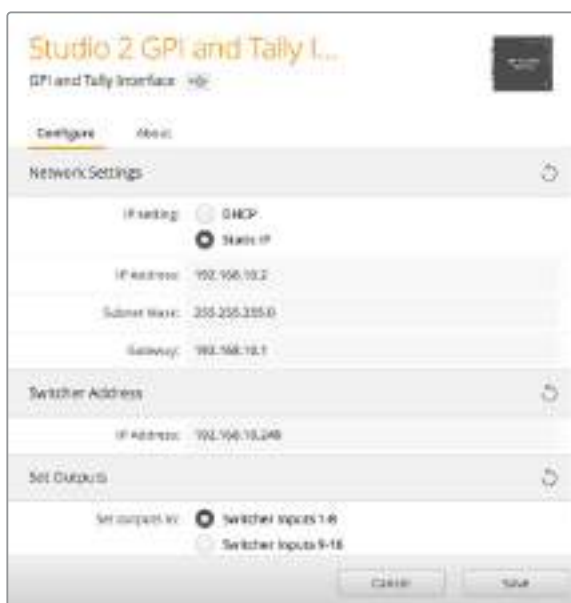
Настройки сети и передачи сигналов для GPI and Tally Interface
