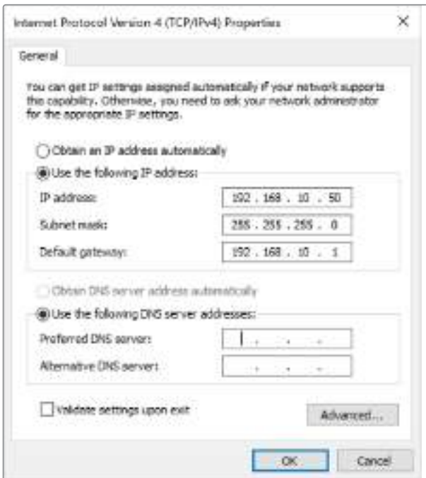
Windows 컴퓨터에서의 IP 주소 수동 설정 모습
