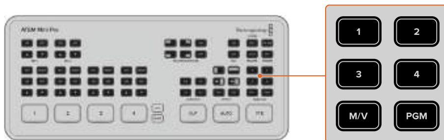
Кнопки в секции VIDEO OUT служат для переключения исходного сигнала, поступающего на выход HDMI
