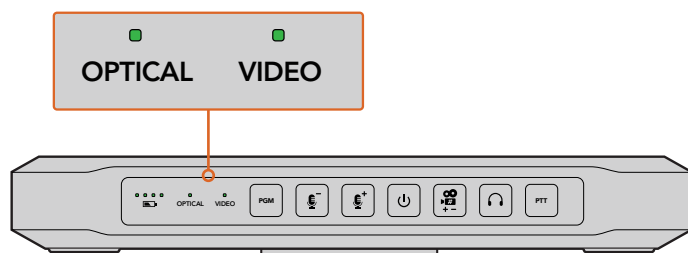
El indicador VIDEO se enciende cuando se detecta una señal SDI o HDMI válida. A su vez, el indicador OPTICAL se ilumina al conectar un cable de fibra óptica.
