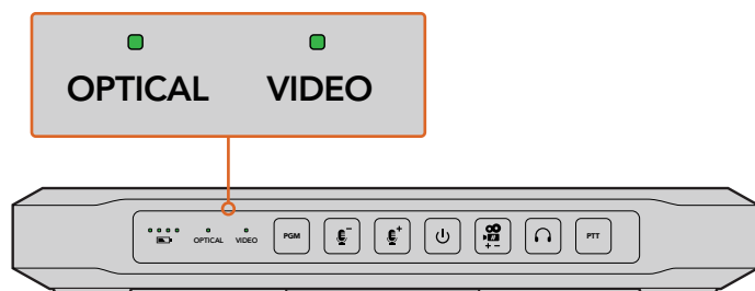
Lorsqu'un signal vidéo valide est détecté via SDI ou HDMI, le voyant Video de l'ATEM Camera Converter s'allume. Le voyant Optical s'allume lorsqu'un signal SDI valide est détecté via l'entrée fibre optique.
