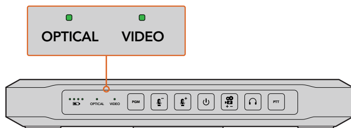
Quando um sinal de vídeo válido for detectado via SDI ou HDMI, você verá o indicador de status "Vídeo" aceso. O indicador "Optical" acenderá quando um sinal SDI válido for detectado via a entrada de fibra óptica.
