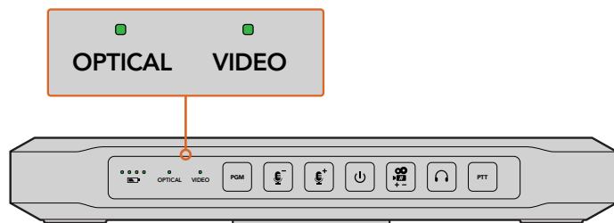
При обнаружении действительного SDI- или HDMI-сигнала на панели ATEM Camera Converter подсвечивается индикатор состояния VIDEO. Индикатор OPTICAL горит, когда на оптический интерфейс устройства поступает действительный SDI-сигнал.
