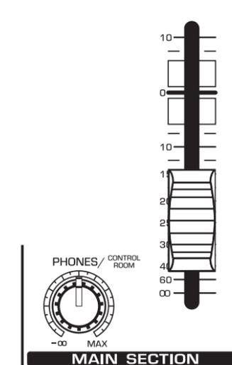
Рис. 2.10: Мониторный регулятор и фейдер Main Mix
