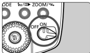
**1** Установите выключатель питания в положение <ON>.
