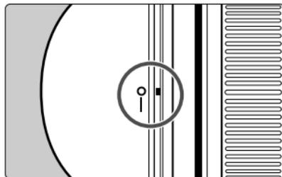
Чтобы подсоединить бленду, выровняйте метку позиции подсоединения на бленде по красной точке на передней части объектива, затем поверните бленду в направлении, как это указано стрелкой, таким образом, чтобы красная точка на объективе совместилась с меткой фиксации бленды в креплении.
