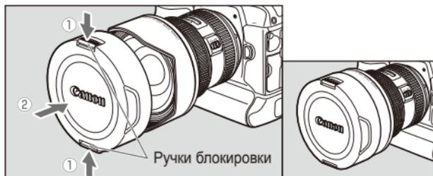
Колпачок объектива можно установить путем сведения ручек фиксации и совмещения крышки объектива по вертикали с блендой объектива, как это показано на рисунке.
