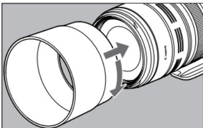
Бленда объектива ET-83С не допускает нежелательные блики и свет на линзы объектива, а также защищает объектив от попадания на поверхность линзы дождя, снега и пыли. Установите бленду на часть крепления бленды, затем поверните ее в направлении стрелки, чтобы надежно закрепить ее на объективе. При хранении объектива можно закрепить бленду на объективе в обратной ориентации.
