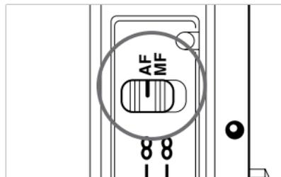
Для съемки в режиме автофокусировки (AF) установите переключатель режимов фокусировки в положение AF.
