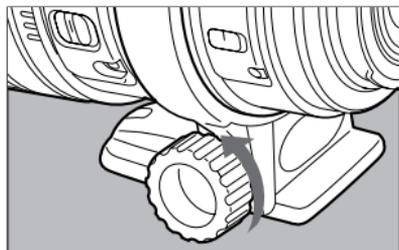
**1** Ослабляют винт замка ориентации.
