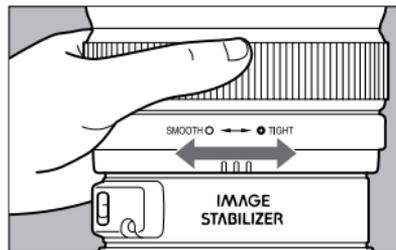
По требованию Вы можете отрегулировать “усилие” (сопротивление) управления трансфокатором, поворачивая кольцо регулировки усилия управления трансфокатором при удержании фокусировочного кольца на месте.
