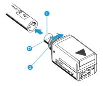
Прочно затяните механический фиксатор 2 в направлении стрелки.
