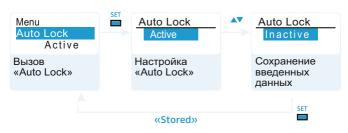
Эта блокировка предотвращает случайное выключение передатчика или выполнение изменений. В текущем стандартном режиме индикации символ замка (5) указывает на то, что блокировка кнопок включена.
