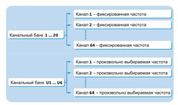
В канальных банках «1» — «20» хранятся заводские предустановки частот (фиксированные частоты). В пределах одного канального банка фиксированные частоты не оказывают взаимных помех. Настройка фиксированных частот не может быть изменена.
