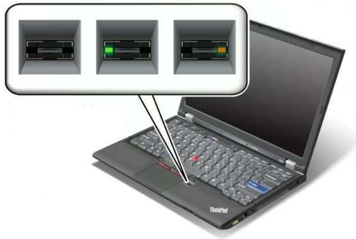
Табл. 4. Состояние индикаторов устройства распознавания отпечатков пальцев
