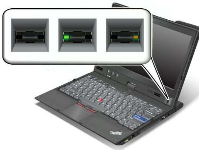
Табл. 5. Состояние индикаторов устройства распознавания отпечатков пальцев
