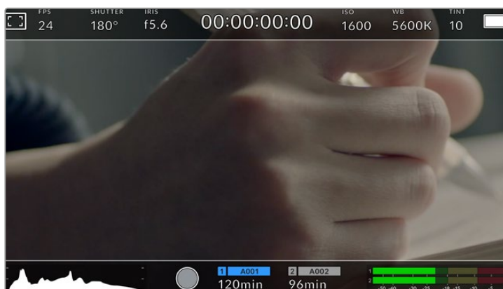
Écran LCD tactile sur lequel le repère de cadrage 2.40:1 est activé.
