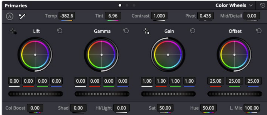
'Lift', 'gamma', 'gain' ve 'offset' renk tekerleri, kliplerinizin renk ve tonlama dengesi üzerinde tam kontrol sağlar. Her bir tonlama bölgesi için renklerin tümüne aynı ayarlamayı yapmak üzere, renk tekerlerinin altında bulunan kadrani, ileri ve geri sürükleyin.
