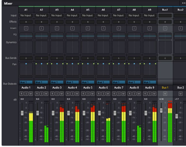
Timeline'deki ses kanallarına karşı düşen kanal şeritleriyle görüntülenen ses mikseri
