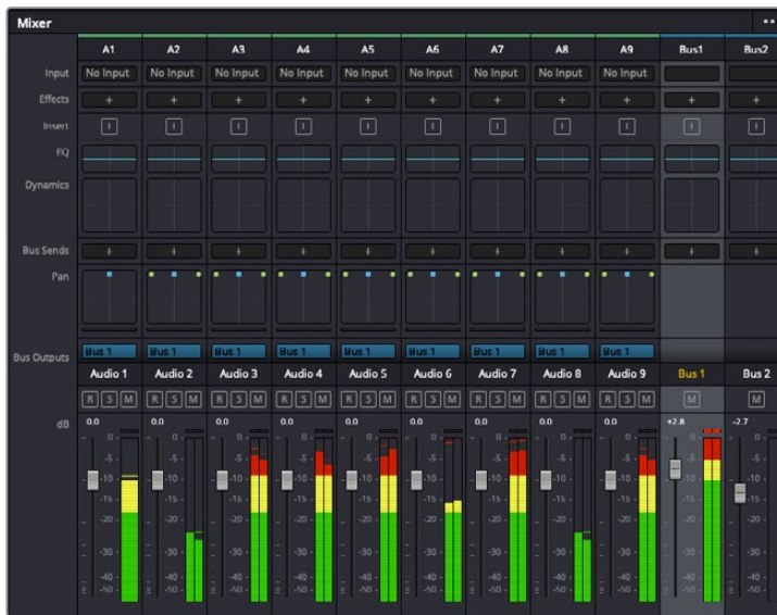
Audiomixer mit den zu den Spuren in der Timeline gehörigen Kanalzügen
