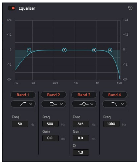
四频段均衡器可应用到时间线上的每个片段
