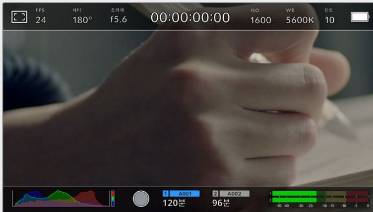
2.40:1 프레임 가이드가 적용된 LCD 터치스크린의 모습
