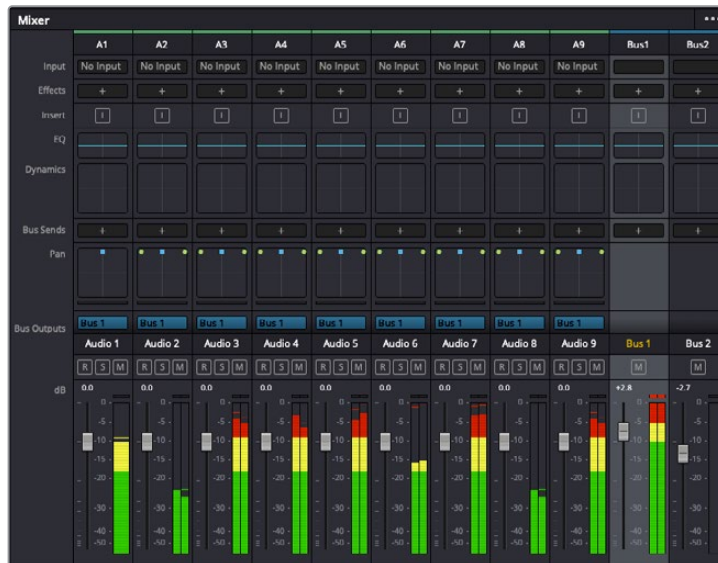
Il mixer audio, con le strisce di canale corrispondenti alle tracce nella timeline
