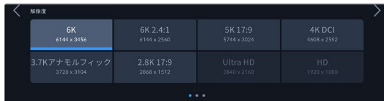
Pocket Cinema Camera 6K Proおよび6K G2でBlackmagic RAWを使用する際の「解像度 (RESOLUTION)」オプション
