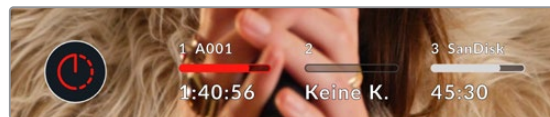
Das in den Aufnahme-Button der Software eingeblendete Icon zeigt den Zeitraffermodus an
