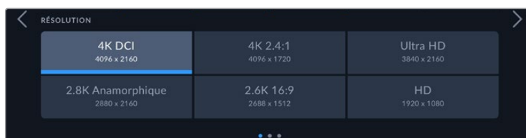
Options de résolution de la Pocket Cinema Camera 4K. En 4K DCI, la catégorie est Résolution , sinon elle sera Résolution - Capteur Window .
