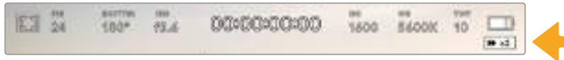
Der Geschwindigkeitsindikator für den Vor- oder Rücklauf zeigt die Geschwindigkeit und Laufrichtung an
