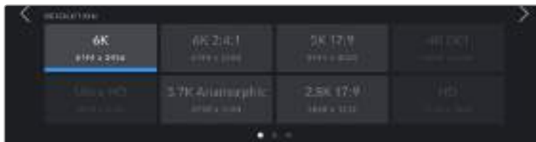
Options de résolution de la Pocket Cinema Camera 6K avec le codec Blackmagic RAW.
