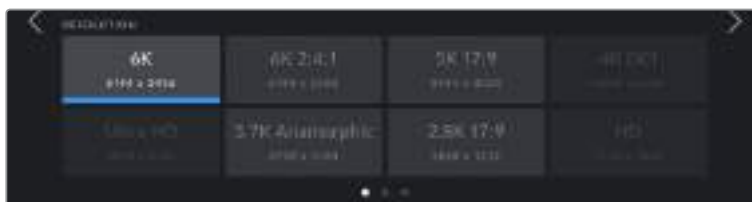
Le opzioni di risoluzione di Pocket Cinema Camera 6K con il codec Blackmagic RAW
