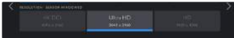
Pocket Cinema Camera 4Kの「解像度 (RESOLUTION)」オプション 4K DCIフォーマットでは、カテゴリーは「解像度 (RESOLUTION)」で、それ以外は「解像度 - ウィンドウセンサー (RESOLUTION - SENSOR WINDOWED)」。
